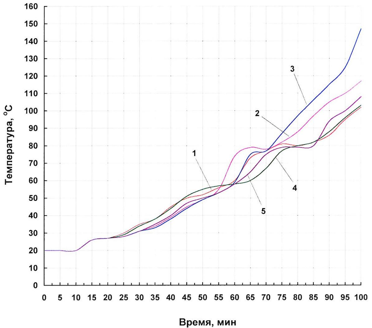
Рисунок 7. Изменения температур в контролируемых точках необогреваемой поверхности при испытании опытного образца № 2 перегородки типа С 362 с обшивками из ГВЛ производства ООО "КНАУФ ГИПС Челябинск"
