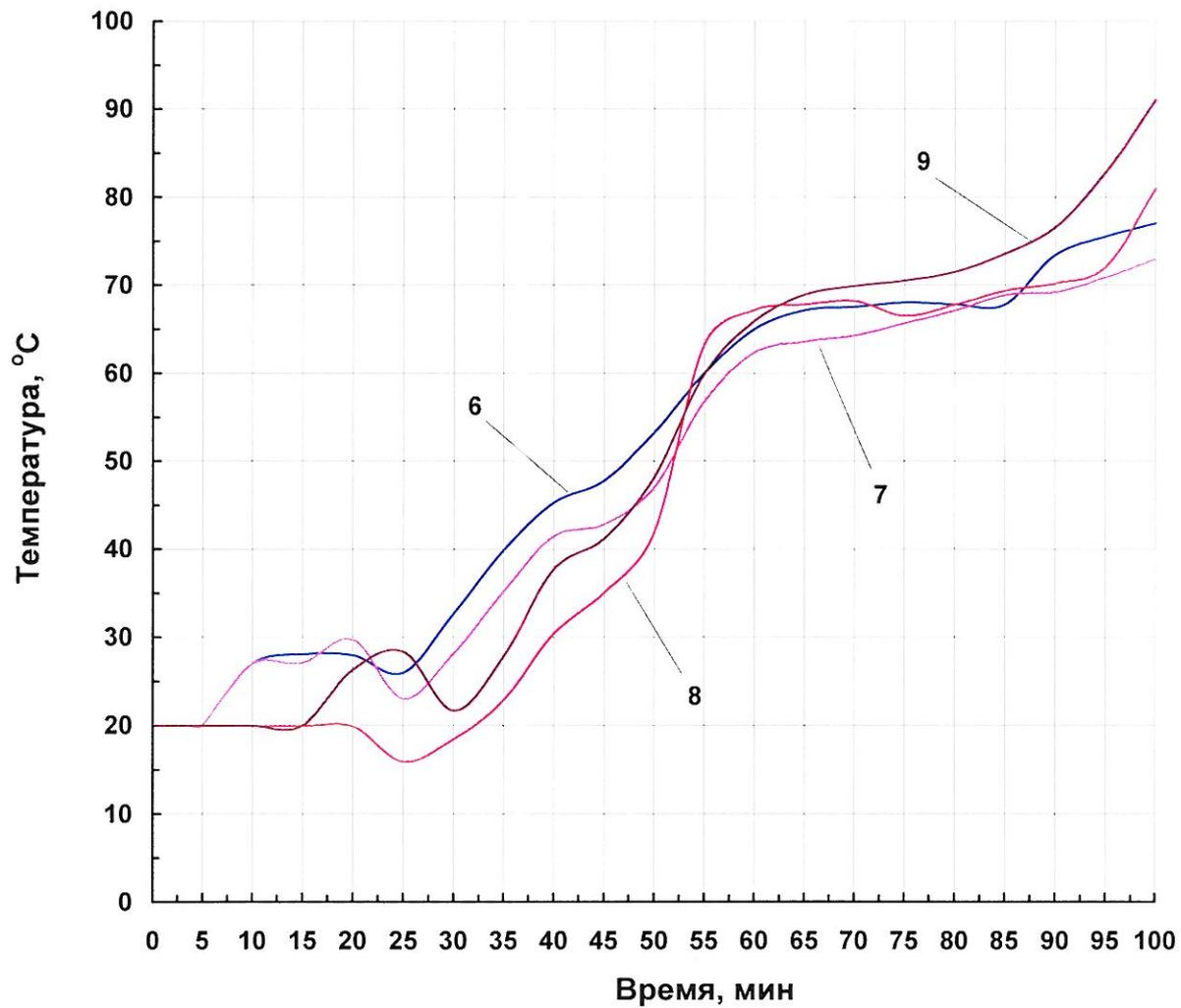
Рисунок 5. Изменения температур в контролируемых точках необогреваемой поверхности при испытании опытного образца № 1 перегородки типа С 362 с обшивками из ГВЛ производства ООО "КНАУФ ГИПС ЧЕЛЯБИНСК"
