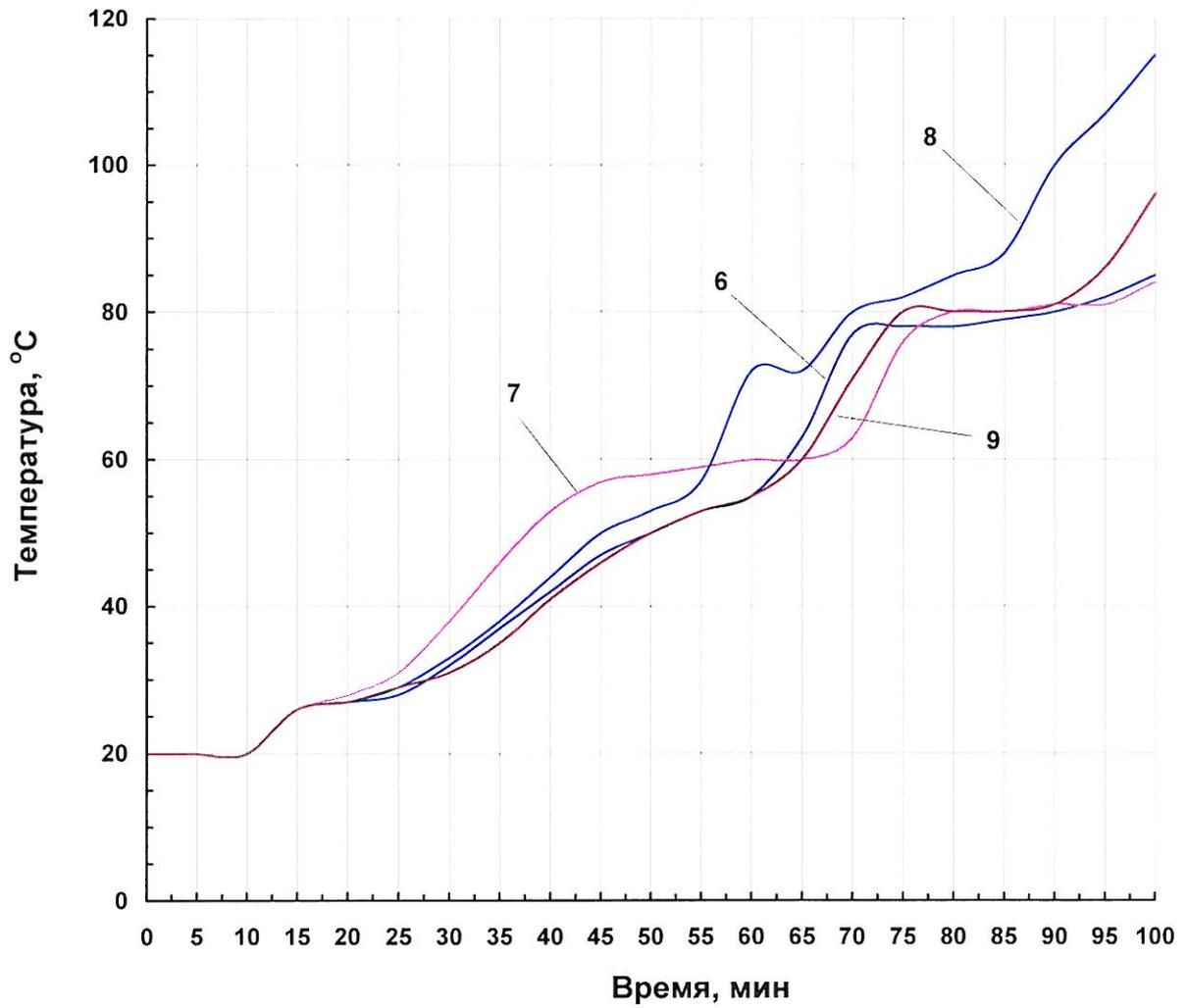
Рисунок 8. Изменения температур в контролируемых точках необогреваемой поверхности при испытании опытного образца № 2 перегородки типа С 362 с обшивками из ГВЛ производства ООО "КНАУФ ГИПС ЧЕЛЯБИНСК"
