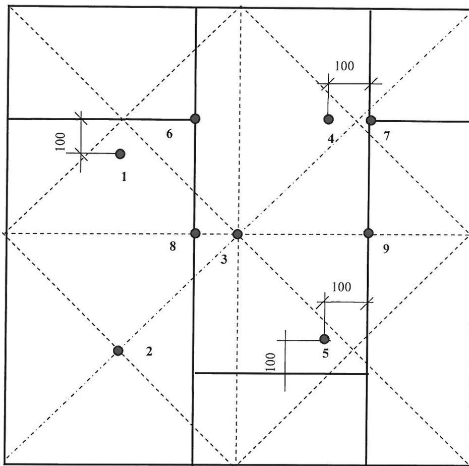
1-9 – места установки соответственно 1-9 термоэлектрических преобразователей на необогреваемой поверхности перегородки
