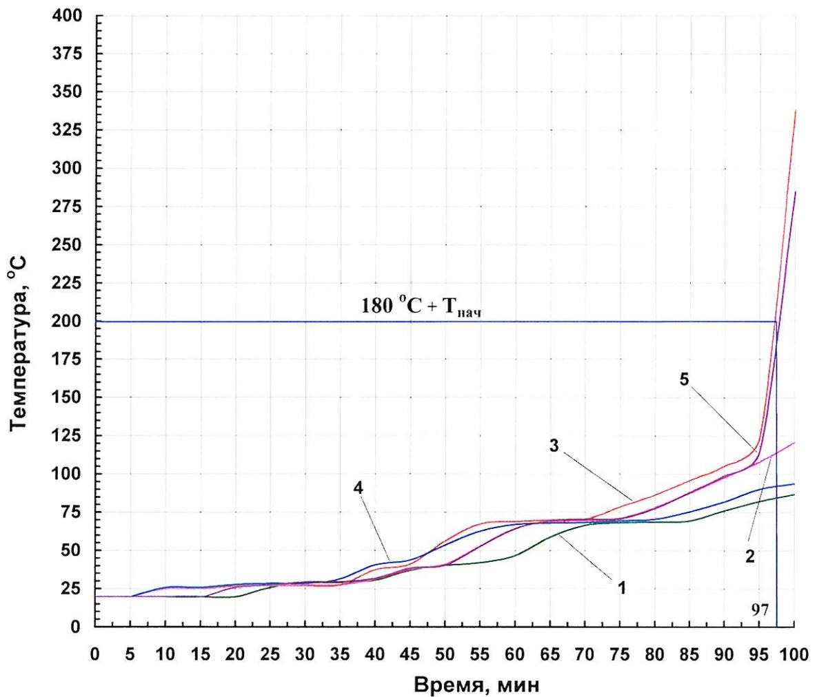
Рисунок 4. Изменения температур в контролируемых точках необогреваемой поверхности при испытании опытного образца № 1 перегородки типа С 362 с обшивками из ГВЛ производства ООО "КНАУФ ГИПС ЧЕЛЯБИНСК"
