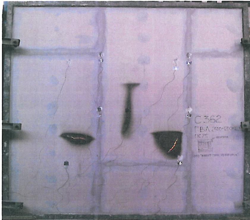
Фото 3. Образец № 1 перегородки типа С 362 с обшивками из ГВЛ
