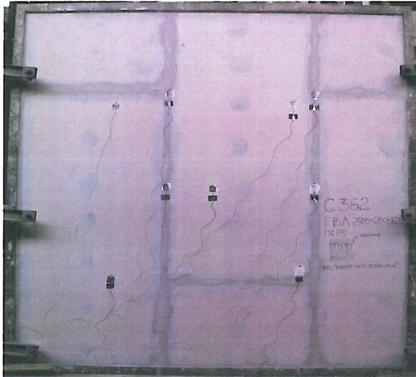
Фото 1. Образец № 1 перегородки типа С 362 с обшивками из ГВЛ до испытания
