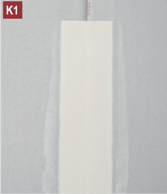
K1: Knauf Uniflott® (1x dolgu işlemi)
