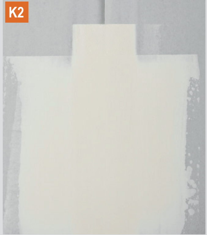
K2: Knauf Uniflott® (2x dolgu işlemi)
