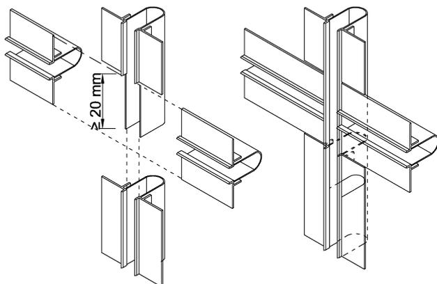
**Figura 6.2:** Formación de juntas. Cruce entre juntas horizontales y verticales.
