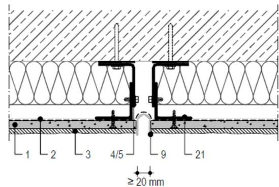
**Figura 5.6:** Junta vertical del sistema (junta de control).
