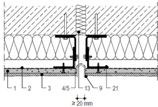
**Figura 5.5:** Junta de dilatación o movimiento del edificio.
