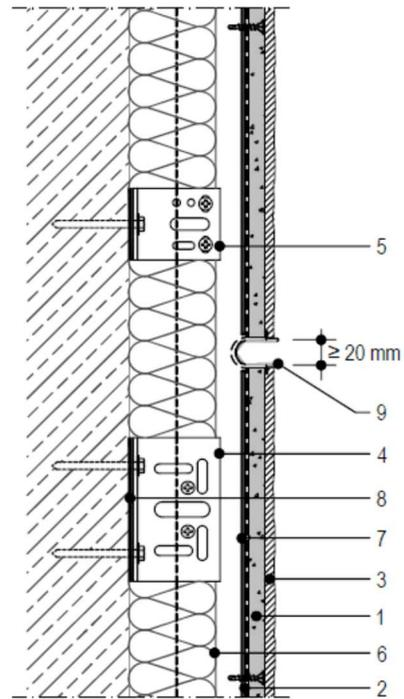
Figura 5.8: Junta horizontal del sistema (junta de control).
