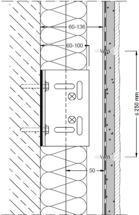
Figura 4.2: Regulación de la cámara del sistema.
