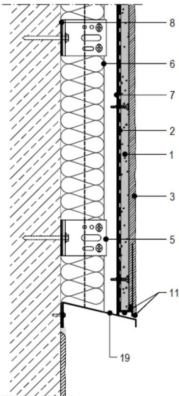
Figura 5.9: Arranque del sistema con cámara ventilada.
