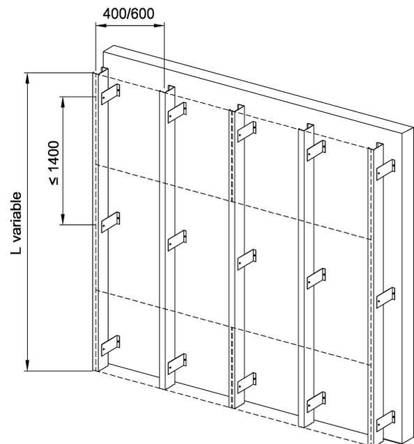
Figura 4.1: Modulación de la subestructura del sistema.
