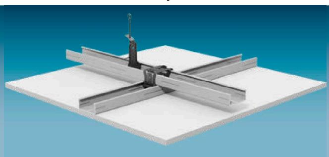
Knauf plāksnes tiek skrūvētas uz metāla karkasa konstrukcijas no nesošajiem un montāžas profiliem (dubultaus profilu režģis vai tikai montāžas profiliem (vienkāršais profilu režģis) – no tērauda CD profiliem 60/27 vai cepurveida profiliem. CD profilus pie pamatgriestiem piestiprina ar iekarēm; cepurveida profilus piestiprina tieši pie pamatgriestiem.
