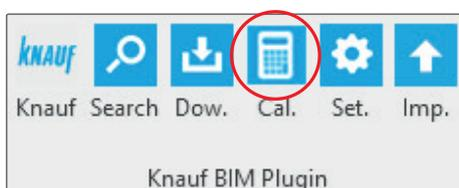
b) Der Mengen Webview berechnet die Mengen und Massen aller im Plan verwendeten Knauf Systemvarianten und zeigt sowohl die Hauptprodukte des jeweiligen Systems, als auch die zusätzlichen Produkte des Systems wie z. B. Schrauben, Spachtelmassen, Klammern etc. inkl. deren jeweiliger Verbrauch für die berechneten Mengen.
