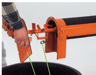
Abb. 44: Mischwelle einsetzen
