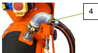
Abb. 46: Wasserschlauch anschließen
