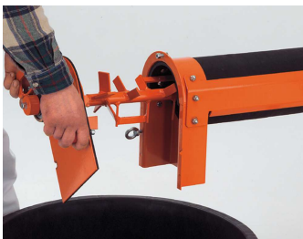
Abb. 39: Mischwelle entnehmen
