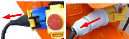
Abb. 34: Stromzuleitung trennen
