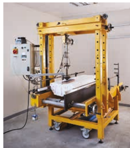
Δοκιμή στρέψης στοιχείων οροφής σε εισαγμένο δοκίμιο
