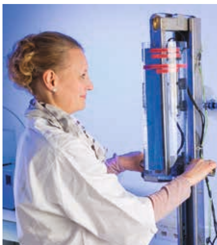
Δοκιμή υγρού εφελκυσμού του χαρτιού
