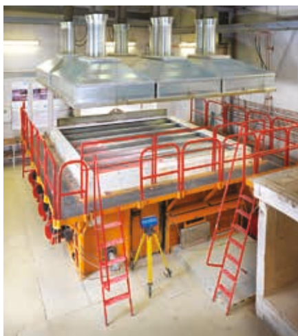
Δοκιμή πυραντοχής σε διάταξη για οροφή διαστάσεων 4 x 4 m
