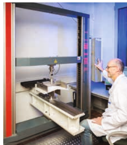
Δοκιμή θραύσης τεσσάρων σημείων σε αρμό γυψοσανίδας
