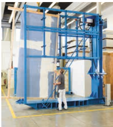
Προετοιμασία διάταξης δοκιμών για μετρήσεις οριζόντιων διατμητικών φορτίων σε τοιχοποιία
