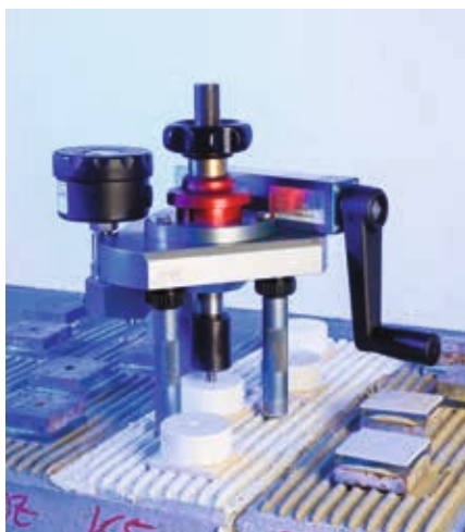
Μέτρηση δύναμης συγκόλλησης των κολλών πλακιδίων
