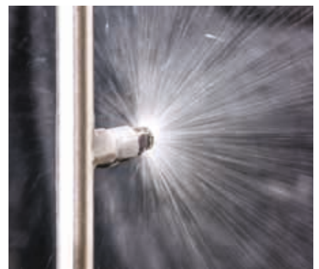
Εφύγγραση προσόψεων σε υδροθερμικό εργαστήριο ελέγχου
