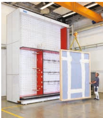
Εγκατάσταση δοκιμίου σε διάταξη δοκιμών για προσόψεις
