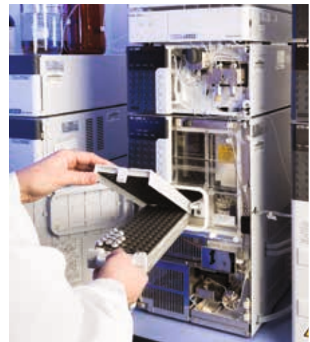
Εξέταση δειγμάτων με τη χρήση ανοικτής, υψηλής απόδοσης, υγρής χρωματογραφίας (HPLC)
