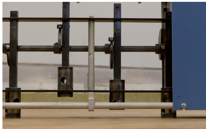
Joonis GS. 5: Ehitusakustiline katsestend löögiheli isolatsiooni mõõtmiseks [Knauf Gips KG]
