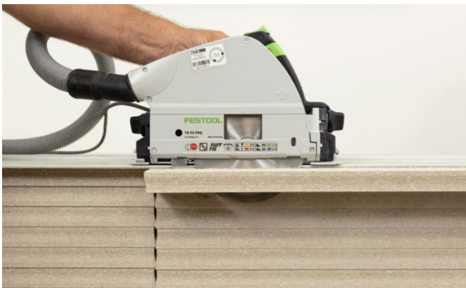
Bild 11: Zuschnitt Wandanschlusselement
