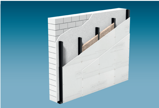
W686.ee Kattesein Knauf AQUAPANEL® CW-postprofiilidel, 2-kihilise plaatkattega
