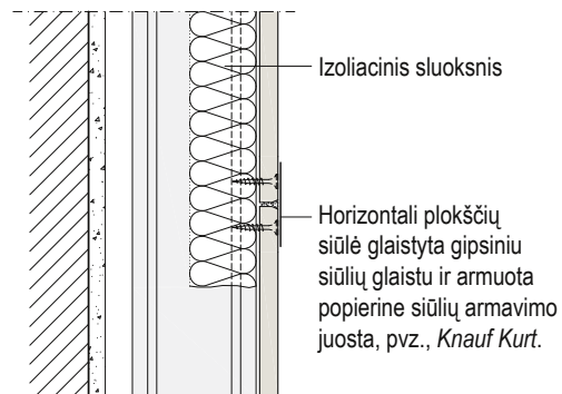
73 pav. Sienų apkalos su mineraline vata pjūvis
