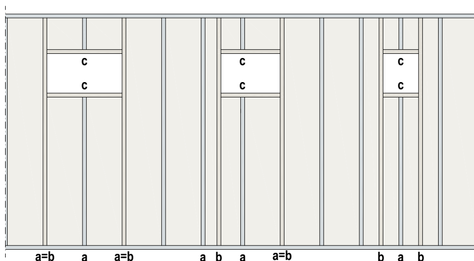
24 pav. Profilių išdėstymas ir įrengiant angas pertvarose. Pagrindinis statramstis (a): pertvaros vertikalūs statramstis išdėstyti leistinu atstumu per visą patalpos aukštį. Keičiamas statramstis (b): vertikalūs, papildomas profilis per visą patalpos aukštį. Pagrindinis statramstis gali būti naudojamas kaip keičiamas statramstis, jeigu anga tiesiogiai ribojasi su pagrindiniu statramsčiu. Keičiamas profilis (c): horizontalus papildomas profilis, skirtas angos aprėminimui tarp keičiamų statramsčių.
