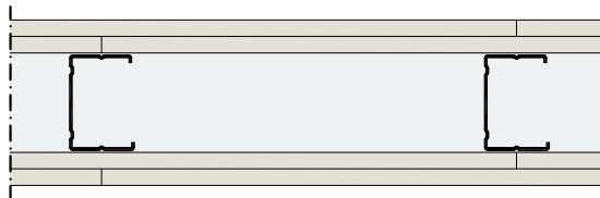
5 pav. Gipskartonio siūlių išdėstymas abeiose pertvaros pusėse
