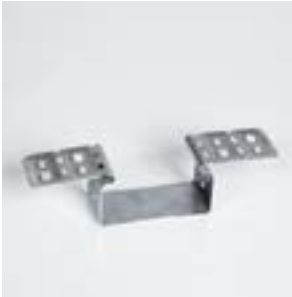
Profilio CD apkaba Befestigungs Clip für CD 60/27 tiesioginio tvirtinimo detalė naudojama tvirtinant prie medinių pagrindų, aukščio išlyginimas iki 27 mm. Kodas: 00003542
