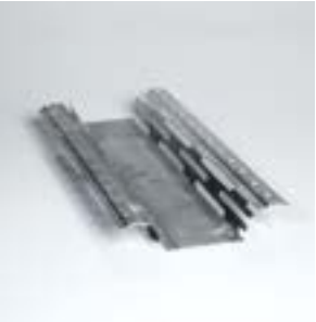
Omega tipo profilis Federschiene 60/27/0,6 erdvę taupantis apkalos tvirtinimo profilis su garso izoliaciniu efektu. Kodas: 00041011
