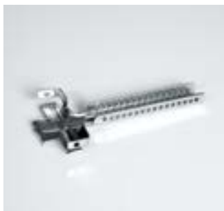
Apatinė Nonius pakabos dalis Nonius-Hänger-Unterteil Nonius pakabos jungimui su CD profiliams, galima tvirtinti skardvaržčius. Galima antikorozinio padengimo klasė: C3-C5M. Kodas: 00003393
