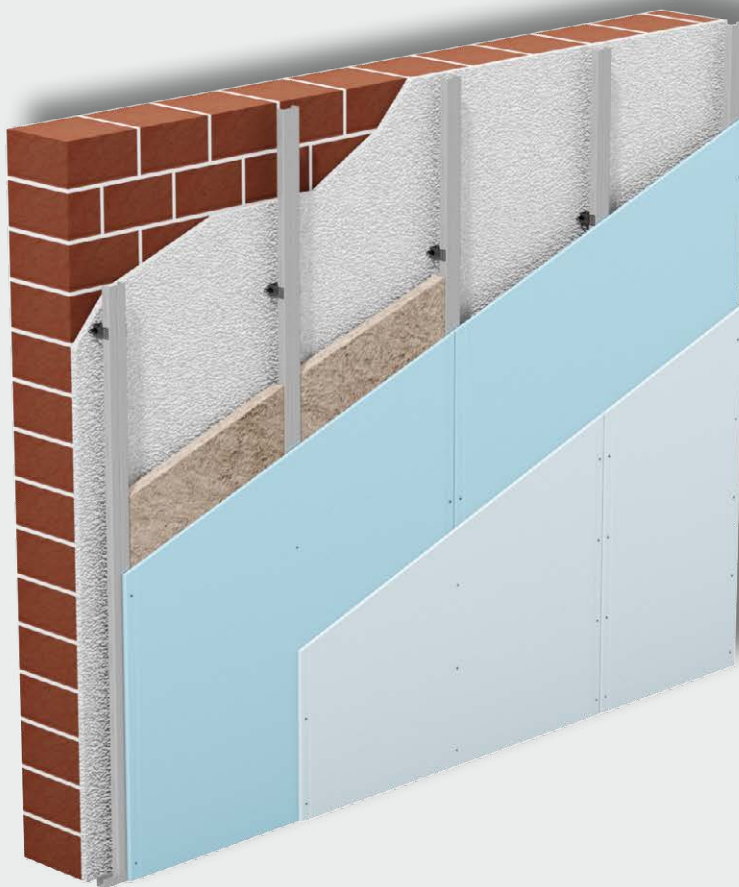
7 pav. Knauf sienos aptaisymas su tiesiogiai pritvirtintu metalinių statramsčių karkasu.
