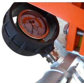
Abb. 29: Mörteldruckmanometer
