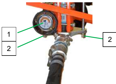
Abb. 47: Muttern lösen.
