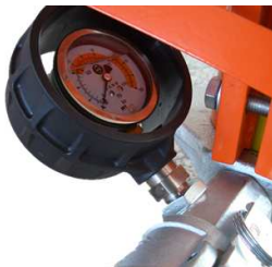
Abb. 17: Mörteldruckmanometer
