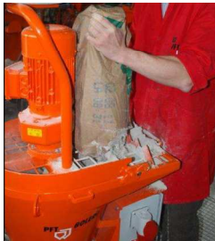
Fig. 35: Fill in bagged material
