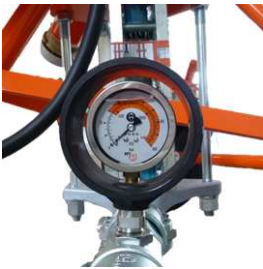
Abb. 17: Mörteldruckmanometer
