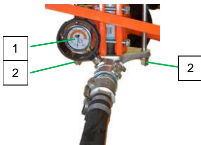
Abb. 47: Muttern lösen.
