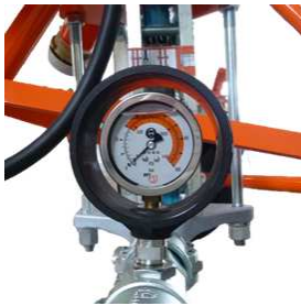
Abb. 29: Mörteldruckmanometer
