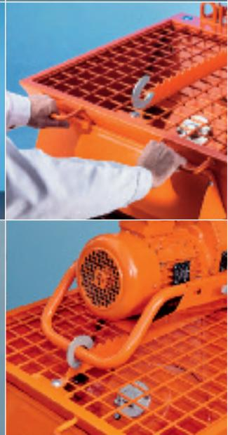
il pratico gancio di sicurezza per la camera di miscelazione permette di ridurre gli ingombri in altezza della macchina per un facile trasporto.
