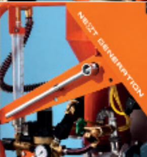
Manutenzione facilitata: ottima accessibilità a rubinetti e pressostati
