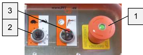
Illustration 41 : Sélecteur du moteur de pompe
