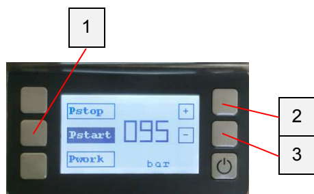
Illustration 36 : Pression d'activation (Pstart)
