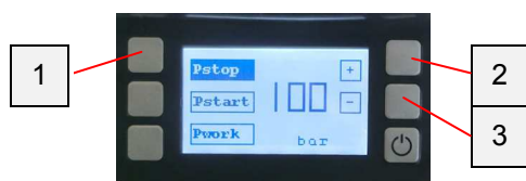
Illustration 35 : Pression de coupure (Pstop)
