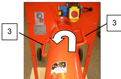
Abb. 41: Mischrohr abnehmen
