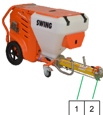
Fig. 73: Unidad de bomba dañada
