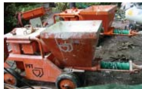
Die beiden Förderpumpen PFT N 2 V, ausgestattet mit einem PFT TWISTER D 4-3, sorgten für einen kontinuierlichen Materialfluss.
