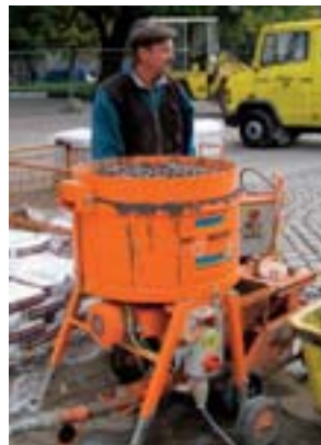
Abgestimmte Maschinenteknik: der Zwangsmischer PFT MULTIMIX kombiniert mit einer Förderpumpe PFT N 2 V.
