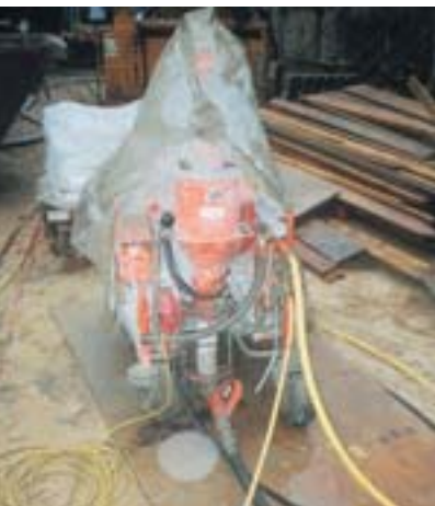
Die Mischpumpe PFT G 4 flexibel im Einsatz: Auf der Restaurierungsbaustelle verpresste sie Bohrlöcher, verfüllte Hohlräume und half beim Aufbringen des historischen Oberputzes.
