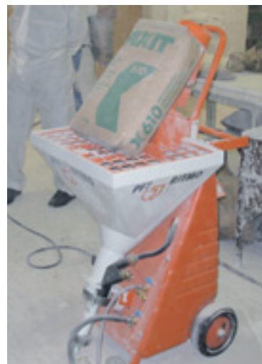
Die Schüler des SMGV bei den ersten Spritzversuchen mit der neuen Mischpumpe PFT RITMO plus M.
