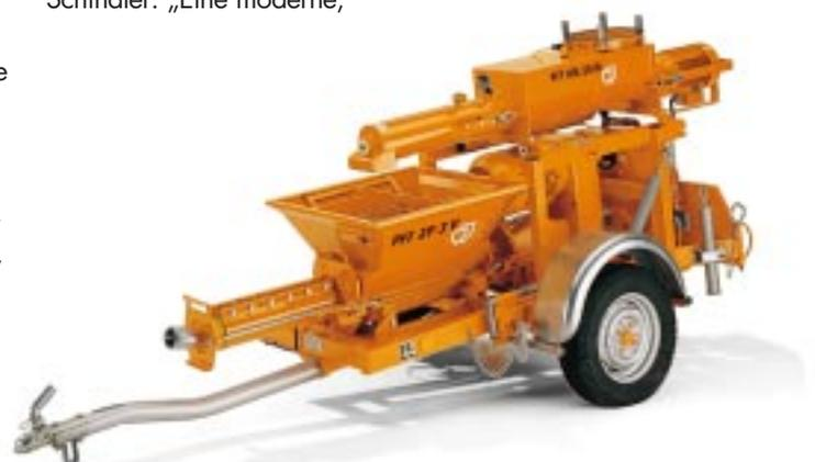
Die PFT OMP als „Dream-Team“ größerer Putzbau- stellen besteht aus einer auf Pkw-Fahrgestell montierten Putz-Mörtel- und Dickstoff- pumpe, die Korngrößen bis 8 mm verarbeiten kann. Die
