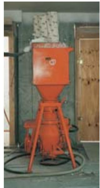
eingesetzt. Über die Einblashaube wurde das Material von der am Boden stehenden PFT SILOMAT in den Etagencontainer pneumatisch geblasen. Von dort aus förderte eine zweite, tragbare PFT SILOMATE 140 das Material bis sozusagen unters Dach. Die Mischpumpe PFT G 4 wanderte, als Verputzmaschine Stockwerk für Stockwerk mit nach oben. Mit diesem PFT Gespann konnten alle Wände des „City-Towers“ in kürzester Zeit problemlos verputzt werden. Zum Schluss waren ca. 130 Meter Förderschlauch installiert.
