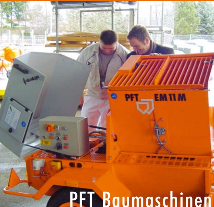
Die neue PFT Baumaschine in KFZ-Hängerausführung, die elektrobetriebene PFT EM 11 M zeigt ihr Können. Die Möglichkeit individuelle Kalk-Zement-Putz-Mischungen in einer Maschine anzumischen und zu verpumpen findet Anklang!
