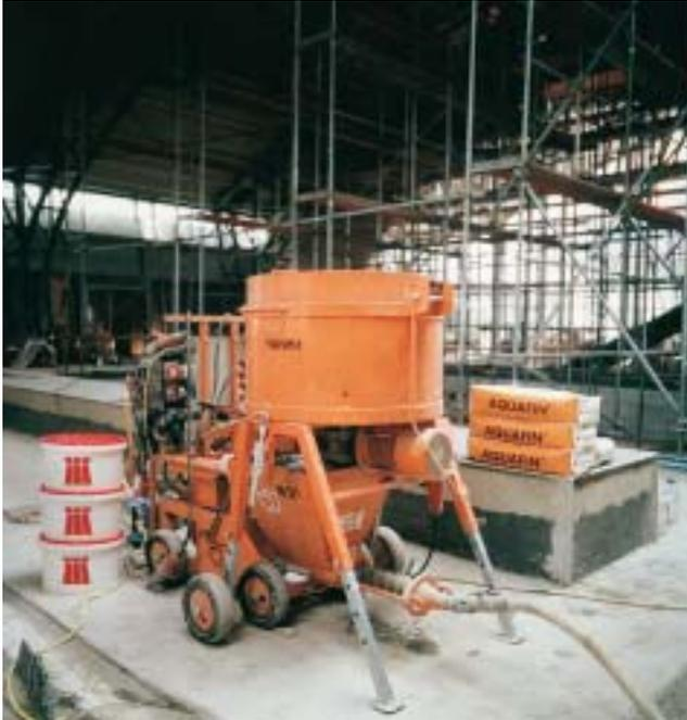
Beide Komponenten der flexiblen Dichtungsschlämme AQUAFIN-2K wurden in dem Zwangsmischer PFT MULTIMIX angemischt und anschließend der Förderpumpe PFT N 2 V zugeführt. Eine einfache und praktische Lösung zur kontinuierlichen Verarbeitung.
