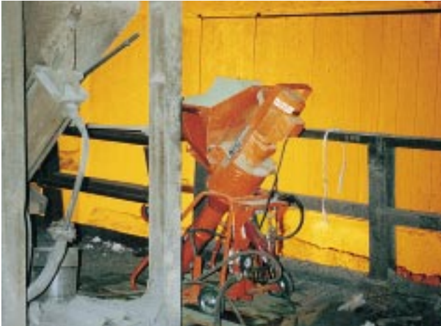
Seine „Feuertaufe“ hat jetzt der PFT MINIJET beim Einsatz in einem Stahlwerk erlebt. Die Aufgabe: Verpressen von Vergussmörtel an einem Konverter.
