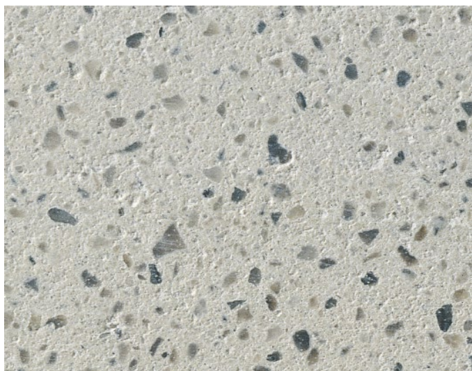
Photo 47: Section transversale d'une chape fluide, quadruple grossissement
