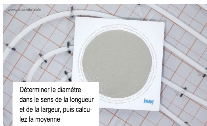
Photo 39: Mesurer le diamètre
