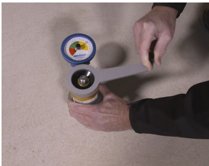
Photo 51: Essai d'adhérence par traction
