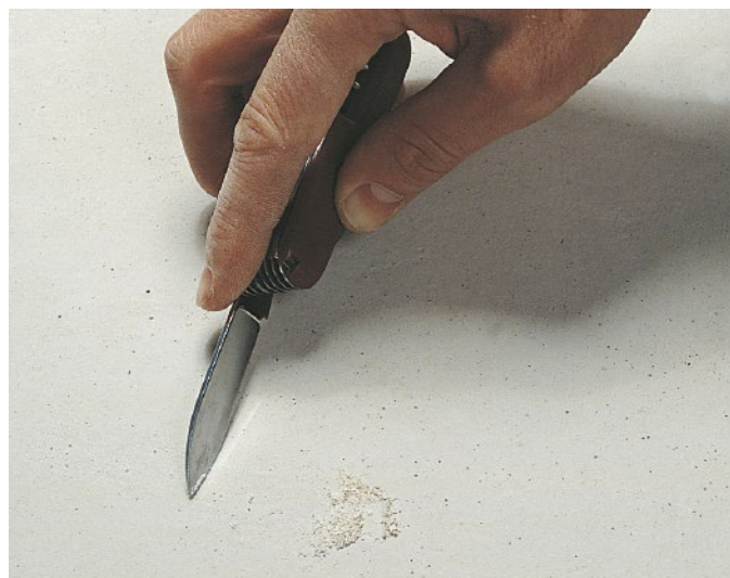
Photo 49: Essai de la structure du grain
