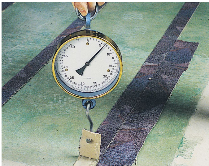
Photo 50: Collage d'essai et vérification de la résistance au pelage
