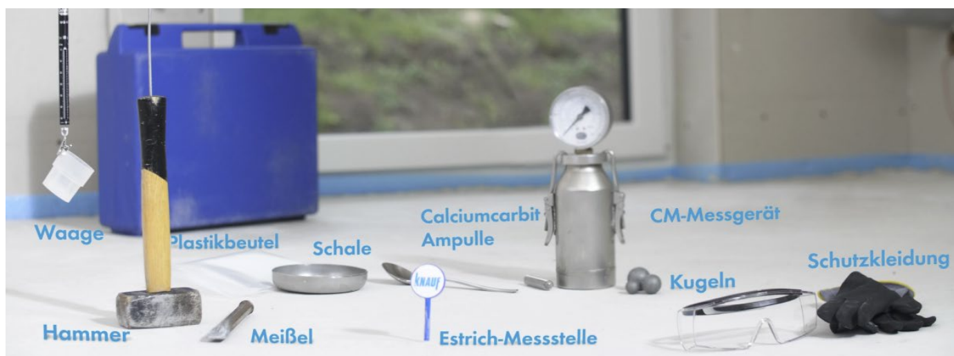
Photo 53: Essai de maturité de pose avec l'appareil CM
