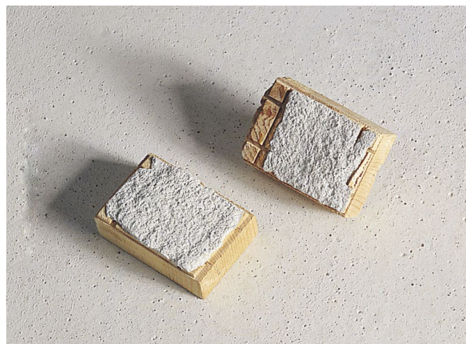
Photo 52: Aspect de rupture du parquet et de la chape
