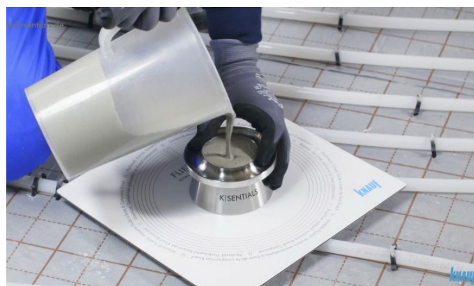
Photo 37: Remplir le cône Hägermann de mortier
