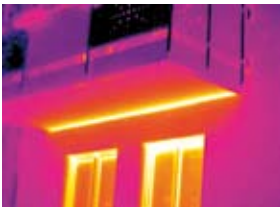
La falta de aislamiento del alféizar de la ventana lleva a una pérdida de energía. El resto de la zona de la fachada está suficientemente aislada.
