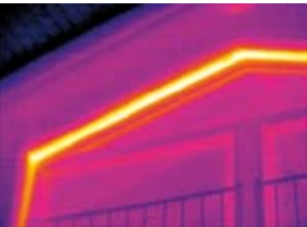
La imagen de infrarrojos identifica las zonas de flujo de calor elevado. Esto lleva a temperaturas superficiales externas más elevadas. Esta termografía de infrarrojos muestra los fallos en la capa de aislamiento de una fachada.
