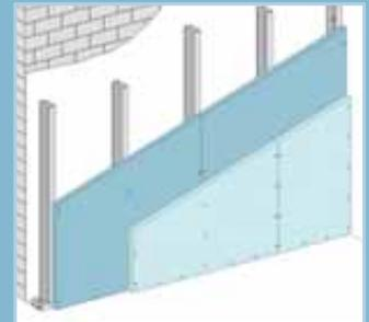
En la cara vista se atornillan las placas Knauf Fireboard. El tratamiento de juntas se realiza con pasta de juntas Knauf Fireboard Spachtel. Cada 15 m de longitud se recomienda una junta de dilatación.
