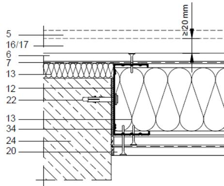
Figura 5.2: Encuentro con pilar del sistema Aquapanel® WM111C.
