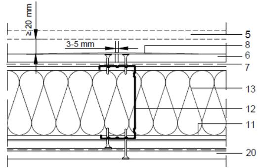
Figura 5.1: Sección horizontal del sistema Aquapanel® WM111C.
