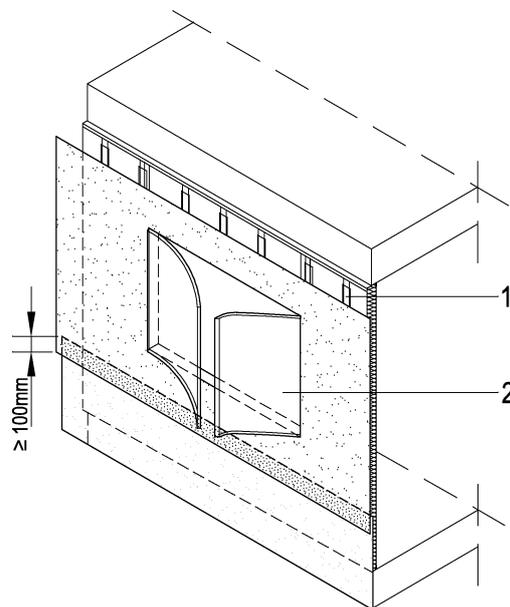
1. Cinta adhesiva de 2 caras para fijación de lámina.
