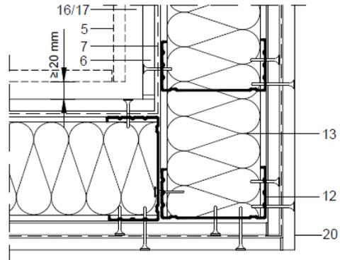
Figura 5.6: Esquina entrante del sistema Aquapanel® WM111C.
