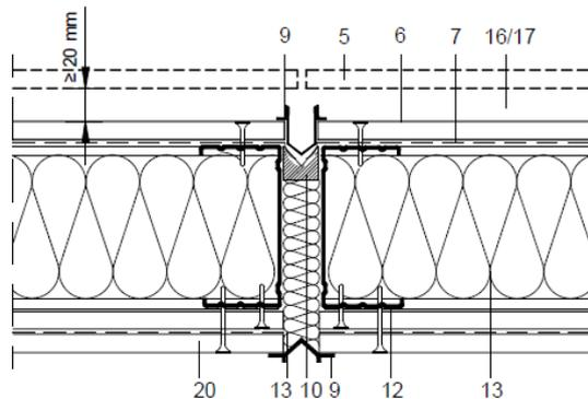
Figura 5.4: Junta de dilatación del sistema Aquapanel® WM111C.
