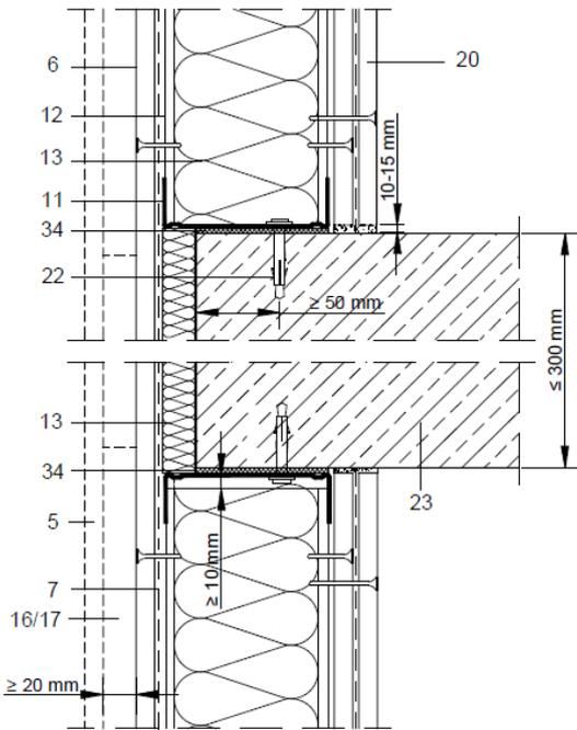
Figura 5.7: Encuentro con forjado del sistema Aquapanel® WM111C.
