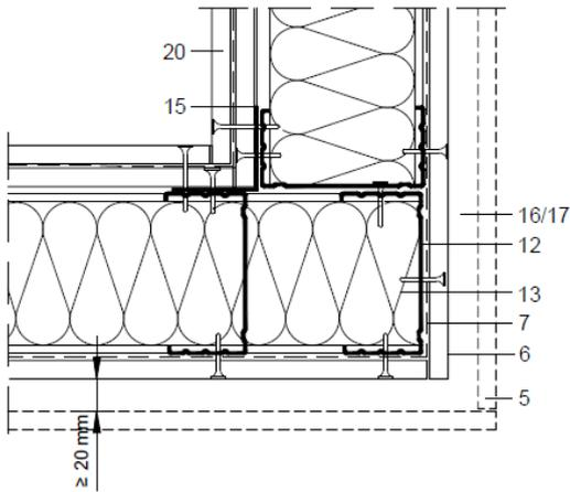
Figura 5.5: Esquina saliente del sistema Aquapanel® WM111C.
