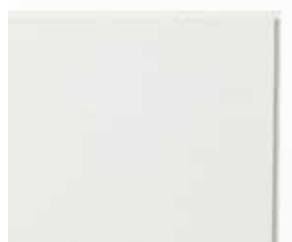
TOPIQ EFFICIENT PRO, hvid RAL 9010. Fremstillet af en 20 mm tyk blød mineraluld med vlieslamineret overflade. Kanterne er forseglet med primer. Kant SK 15/24 el. VT-S 24. Her vist med VT-S kant.
