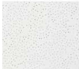
STAR klassisk mineraluldsloft, Hvid RAL 9010. Fremstillet af en 15 mm tyk sammenpresset mineralfiber. Fremstillet ved vådfiltningproces. Flot hullet stjernemønster i overflade. Kant SK 15/24.
