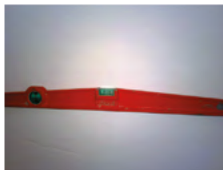
Trace a linha inferior com um nível
