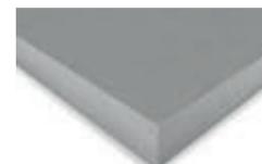
Composta por um núcleo de gesso enriquecido com fibra de vidro. Placa utilizada no sistema Shaftwall que protege do fogo até 3 horas e oferece uma alta resistência mecânica graças a placa Maciza 20 além que facilita a sua instalação por um só lado graças ao desenvolvimento de um Montante especial CT.
